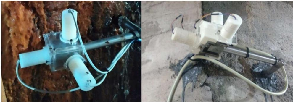
FIGURA 5 – Automação de medidor triortogonal
