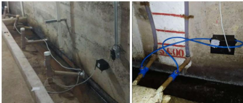
FIGURA 6 – Automação de drenos (esquerda) e piezômetros de tubo aberto (direita)
